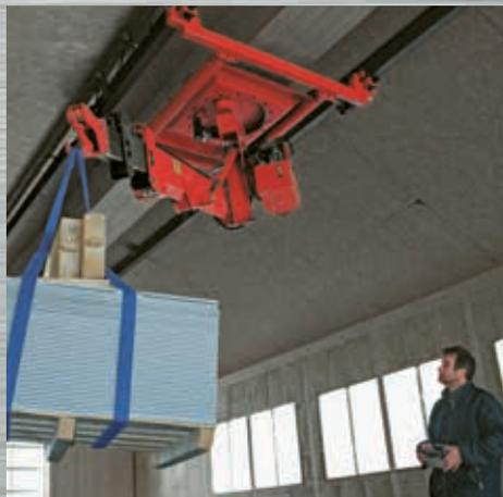
Stationäre Krananlage mit Funkfernsteuerung
